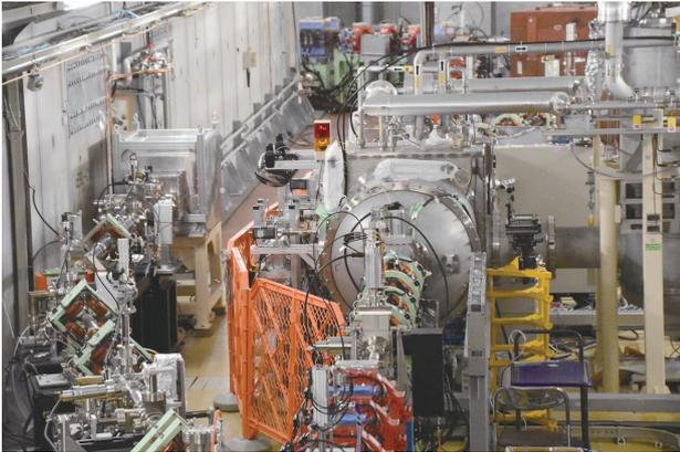
図4：cERL 加速器室の内部。中央には超伝導空洞を収容したクライオスタットが見える
